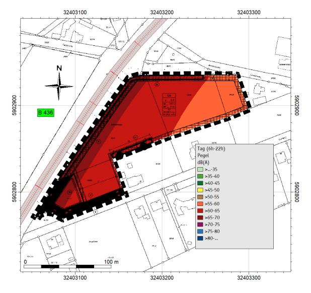
**Abbildung 3:** Beurteilungspegelverlauf im **Tagzeitraum** auf dem Plangebiet unter Berücksichtigung von Straßenverkehr, relative Höhe 4,8 m (hinterlegter Plan: Quelle [12]).
