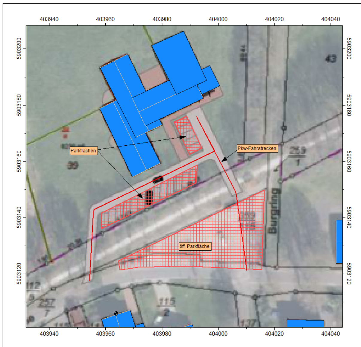
Abbildung 7: Lage der Schallquellen inkl. des öffentlichen Parkplatzes.
